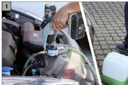
Diese praktische und werkstatthaft konstruierte Hydraulikpumpe dient zum Abpumpen bzw. Um- und Befüllen aller nicht leicht entflammbarer Flüssigkeiten wie z.B. Motor- und Getriebeöl, Kühlerfrostschutz, Bremsflüssigkeit, etc. Der Antrieb der Pumpe erfolgt dabei entweder elektrisch, mit Hilfe eines Akkuschraubers oder wahlweise auch pneumatisch mit Hilfe einer Luftratsche bzw. eines Schlagschraubers.
