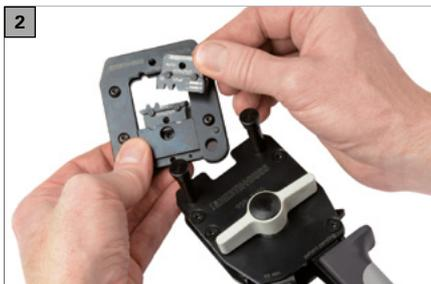
Die CrimPro 40 ist für die unterschiedlichsten Anwendungen geeignet. Mit der Schnellwechsel-Adaption von Werkzeugköpfen kann das Basiswerkzeug schnell und unkompliziert auf den jeweiligen Verarbeitungsbedarf umgerüstet werden. Das Sortiment an Crimpeinsätzen ermöglicht die Verarbeitung von Steckverbindern unterschiedlichster Querschnittsbereiche und Baugrößen. Durch die hohe Presskraft ist die CrimPro 40 mit den passenden Adaptern
