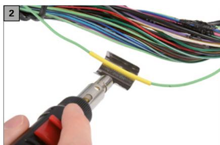
Der Burner ist durch die einstellbare Gaszufuhr und den im Lieferumfang enthaltenen Aufsätzen für verschiedenste Arbeiten, wie z.B. für das fachmännische Erhitzen von Schrumpfschläuchen oder das Einlöten von Kabelschuhen geeignet.
