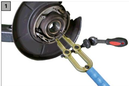
Dieses Werkzeug wird zur Demontage und Montage von Sicherungsringen verwendet. Im Vergleich zu herkömmlichen Seegeringezangen muss der Sicherungsring nicht mit Muskelkraft auf Spannung gehalten werden. Somit wird selbst die Montage von größeren heavy-
