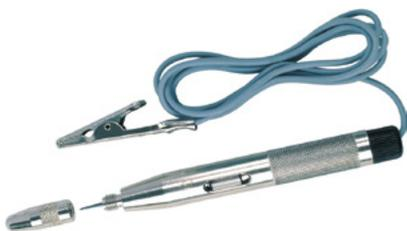
Zur Feststellung von Störungen in Lichtenanlagen und zur Prüfung bzw. Einstellung kontaktgesteuerter Zündanlagen.
