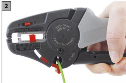
Mit diesem hochwertigen Abisolierwerkzeug können sowohl massive als auch feindrähtige Leiter mit PVC Isolation von 0,03 – 16mm<sup>2</sup> beschädigungsfrei abisoliert werden. Eine Beschädigung und ein Aufspießen der Leiter wird durch die intelligente Selbsteinstellung auf die Querschnittsbereiche verhindert. Die integrierte Schneidefunktion (mit Handschutz) ermöglicht zusätzlich das präzise Schneiden von massiven (bis 6 mm<sup>2</sup>) und feindrähtigen
