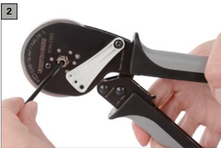
Das Crimpwerkzeug ermöglicht den präzisen Sechskant-Crimp von Aderendhülsen mit und ohne Isolierkragen. Aderendhülsen mit einem Querschnittsbereich von 0,08 mm<sup>2</sup> - 16,0 mm<sup>2</sup> können problemlos in einem Werkzeug ohne Verstellung verarbeitet werden. Dank des angebrachten Schwenkpositionierers werden auch Aderendhülsen mit kleinem Querschnitt anwendungssicher verarbeitet. Der Schwenk-
