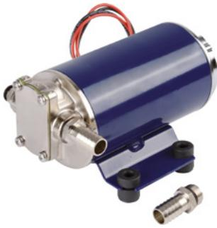
Selbstansaugende kleine Elektropumpe mit Bronzeshnradern, besonders zum Umfüllen von Öl oder dickflüssigen Flüssigkeiten geeignet. Gehäuse aus vernickeltem Messing, Spindel aus rostfreiem Stahl.
