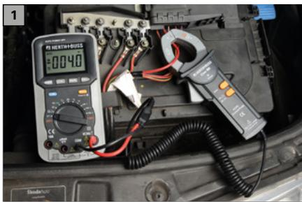
Die Strommesszange eignet sich für die Messung von hohen Strömen bis 400 A.
