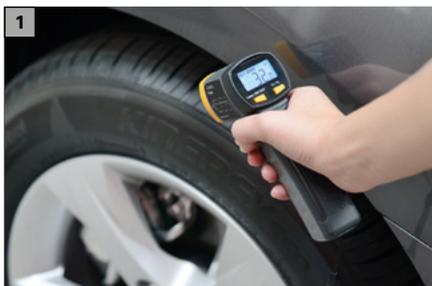
Das Thermometer eignet sich zur berührungslosen Messung der Oberflächentemperatur:
