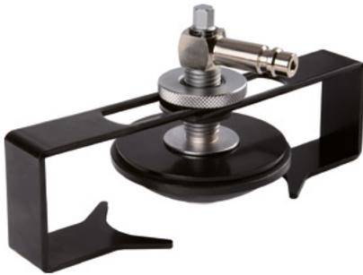
Variabel verstellbare Fixierflügel und die variable Höhenverstellung ermöglichen einen sehr universellen Einsatz des Adapters an nahezu allen Fahrzeugtypen. Besonders da wo der Euroadapter nicht passt. Kompakte, sehr stabile Bauweise und die kegelförmige Abdichtungsfläche aus bremsflüssigkeitsresistentem Gummi gewährleisten einen sicheren Halt und eine zuverlässige Abdichtung während der gesamten Prozedur.
