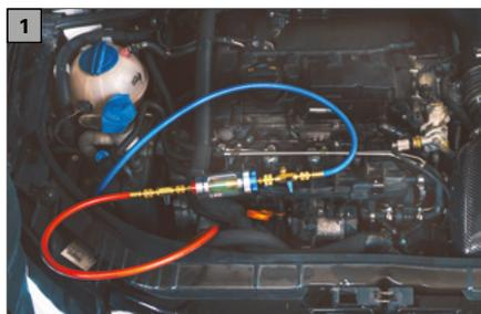
Dieses Schauglas ermöglicht eine Sichtprüfung des Kältemittels bzw. des Kompressoröls und liefert wertvolle Informationen zum Zustand des Kältemittels. Es kann beispielsweise kontrolliert werden, ob Späne oder sonstige Fremdkörper sich in der Anlage breit gemacht
