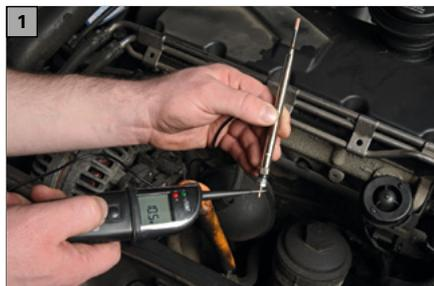
Erleichtert die Fehlersuche an elektrischen Anlagen im Kfz. Verschiedene Bauteile wie Relais, Lampen, Elektromotoren usw. können durch Anlegen der Batteriespannung und/oder Masse angesteuert und überprüft werden. Durch die induktive Hochspannungs- und Frequenz-
