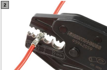
Die Quetschzange eignet sich für die Verarbeitung von nicht isolierten Kabelschuhen (DIN 46234, DIN 46230, DIN 46341) mit geschlossener Crimphülse. Die entriegelbare Zwangs-
