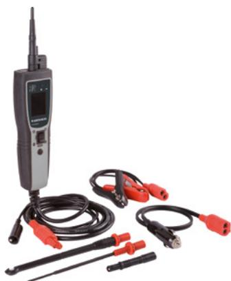
Erleichtert die Fehlersuche an elektrischen Anlagen im Kfz. Verschiedene Bauteile wie Relais, Lampen, Elektromotoren usw. können durch Anlegen der Batteriespannung und/oder Masse angesteuert und überprüft werden.
