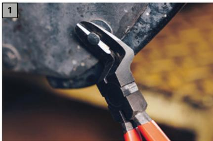
Diese speziell geformte Zange eignet sich hervorragend zum Greifen, Ziehen und Aufhebeln von nahezu allen Kunststoff-Clip Ausführun-
