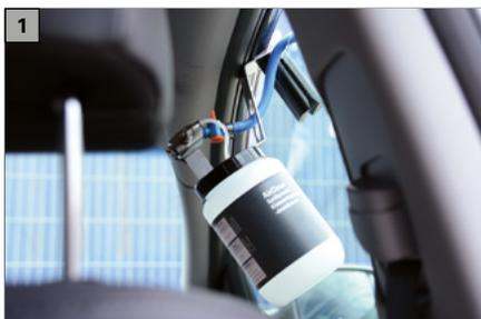
Mit AirClean erweitern wir unser Portfolio im Bereich der Klimaanlagecleanung. Über die Lecksuche hinaus bieten wir mit AirClean die Möglichkeit, ohne großen Aufwand und ohne Belastung der Umwelt eine Desinfektion der Fahrzeugklimaanlage bzw. des Fahrzeugs durchzuführen. AirClean eignet sich für alle Fahrzeugtypen, Kfz, Transporter, Lkw, Wohnmobile etc.
