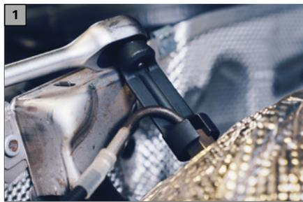
Die Steckschlüsseinsätze sind so geformt, dass sie auf nahezu alle Abgastemperatursensoren und Lambdasonden passen. Die ver-
