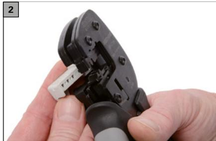
Die Crimpzange CrimPro 30 erfüllt höchste Ansprüche an Qualität und funktionellen Einsatz. Ausgerichtet auf die industrielle Anwendung können mit unterschiedlichen Crimp-Sets Querschnittsbereiche von 0,1 bis 25 mm<sup>2</sup> verarbeitet werden. Professionelle Crimppräzision durch lineare Arbeitsweise der Gesenke für alle gängigen Kontakte. Das Doppelführungs-
