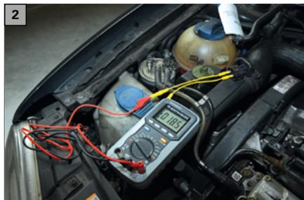
TesTip ist ein Set verschiedener Messleitungsadapter, das eine vereinfachte Fehlersuche sowie einen sicheren Signalabgriff durch Direktkontaktierung bei elektrischen Kfz-Komponenten ermöglicht. Das 94-teilige Kofferset enthält die gängigsten Kontaktgrößen. Weiter beinhaltet das Set Polaritätsprüfer mit denen Hallgeber und Photosensoren prüfbar sind sowie
