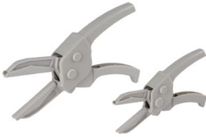
Die Universal-Feststellzangen werden zum Abklemmen von diversen Kühlwasser- und Unterdruckschläuchen verwendet. Sie verhindern unter anderem das Auslaufen des Kühlwassers bzw. das Leerlaufen des Kühlsystem, wenn beispielsweise Wasserpumpen, Thermostate, Stutzen etc. ausgetauscht werden. Somit bleibt auch eine aufwendige Entlüftung des Kühlsystems erspart.
