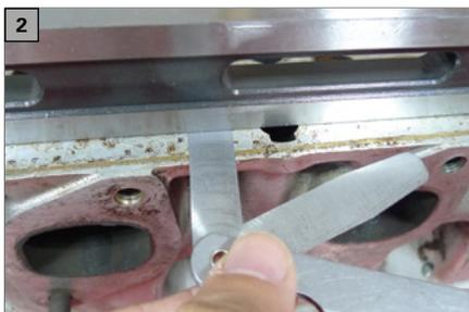
Das Haarlineal ist ein Messwerkzeug, das zur Ebenheitsüberprüfung einer Fläche mittels Lichtspaltverfahren eingesetzt wird. Das Haarlineal wird speziell zur Überprüfung von Zylinderköpfen bei einem Wechsel der Zylinderkopfdichtung verwendet. Wird der Motor über-
