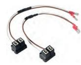
Keramik-Glühlampenanschlussstecker für H7- Glühlampen ist in der Pluszuleitung mit einer Diode versehen. Diese Diode senkt die anliegende Spannung um 0,8 V auf eine optimale Glühlampenspannung. Dadurch wird die H7-Glühlampe vor erhöhten Spannungsspitzen geschützt und die Lebensdauer erhöht. Die Lichtleistung bleibt voll erhalten. Einschränkung: kann nur bei Fahrzeugen mit abziehbaren Lampen- Steckanschluss verwendet werden. Bitte nur paarweise verwen-
