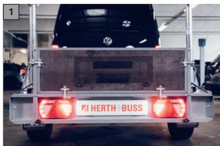
Eine LED-Multifunktionsleuchte mit integriertem Steuergerät für alle Leuchtenfunktionen. Das eingebaute LED-Steuergerät behebt das Kompatibilitätsproblem beim Umbau von Glühlampen Heckleuchten auf LED-Heckleuchten.
