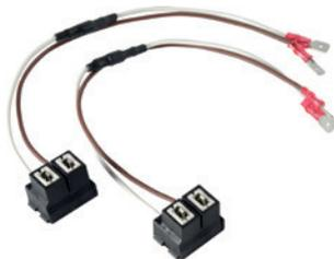
Der Keramik-Glühlampenanschlussstecker für H7- Glühlampen ist in der Pluszuleitung mit einer Diode versehen. Diese Diode senkt die anliegende Spannung um 0,8 V auf eine optimale Glühlampenspannung. Dadurch wird die H7-Glühlampe vor erhöhten Spannungsspitzen
